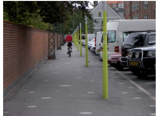
Abbildung 236: Beispiel einer Wegemarkierung mit Farbpunkten auf der Gehwegfläche und gelben Stäben, welche hier zugleich die Beleuchtungskörper enthalten.
