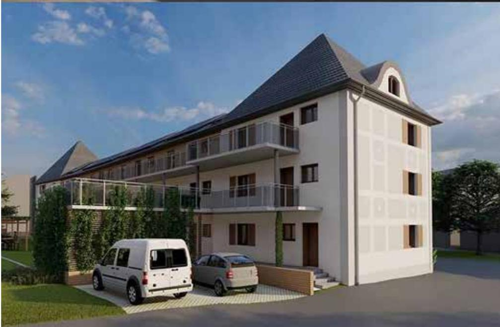
*Die wichtigsten Umbaumaßnahmen betreffen die Treppenhäuser, sie sollen entfallen, denn der Zugang zu den Wohnungen soll in Zukunft über einen Laubengang an der Ostseite des Hauses erfolgen. Der Mittelteil soll aufgestockt und die Dachgauben und Kamine entfernt werden. Außerdem ist vorgesehen, das Gebäude mit einem Vollwärmeschutz zu versehen und auf dem Dach eine Photovoltaikanlage zu errichten, um hier das Konzept des Mieterstroms umzusetzen.*
